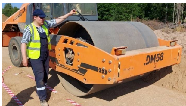
Рис.3. Измерения вертикальных перемещения вальца катка DM-58 лазерным датчиком BAUMER OADM 13U6480/S35A
