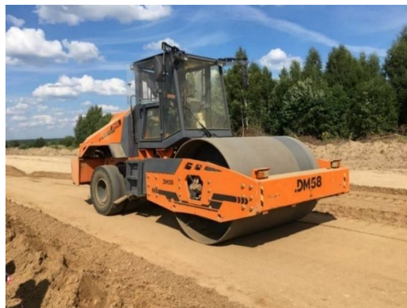
Рис. 1. Комбинированный вибрационный каток DM-58 на экспериментальной площадке
