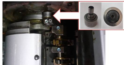
Рис.5. Расположение опорного ролика
